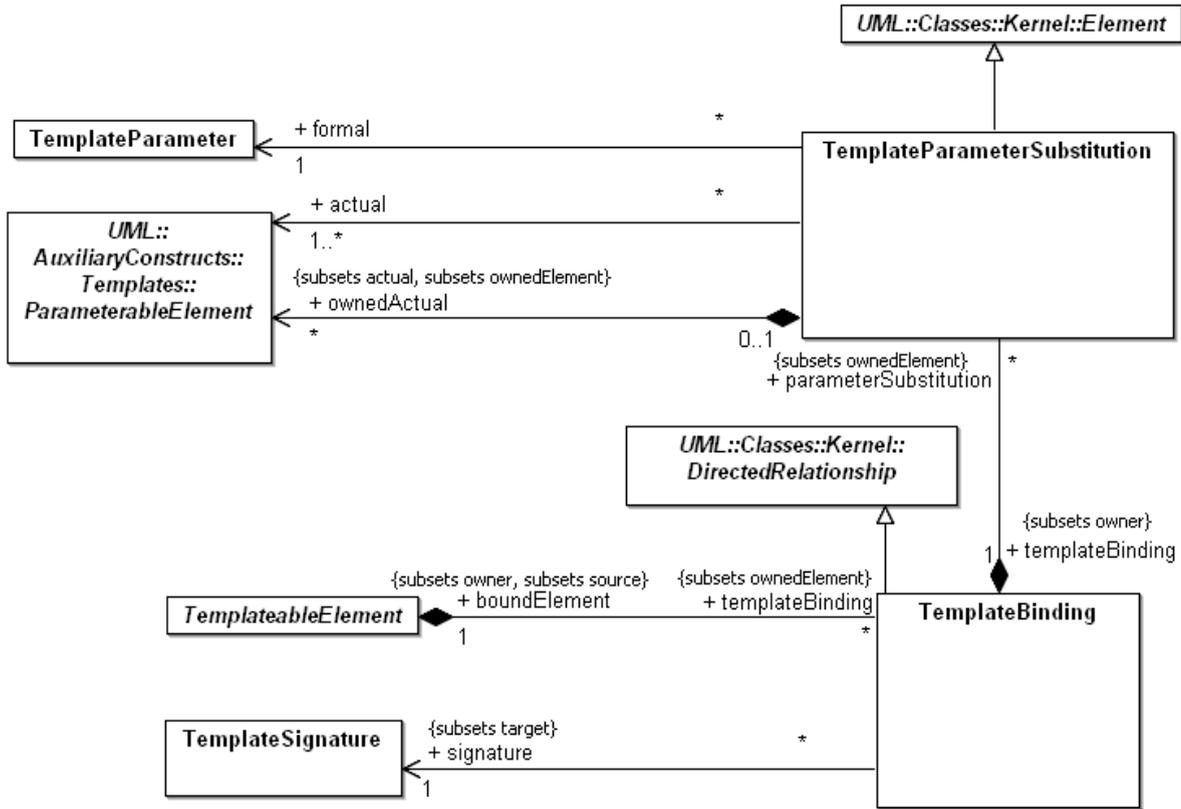
Figure 17.17 - Template parameters
